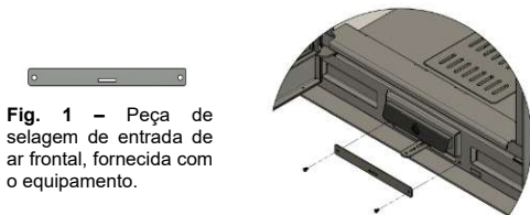
Fig. 2 - Remover os parafusos; posicionar a peça de selagem e tornar a apertar os parafusos.
