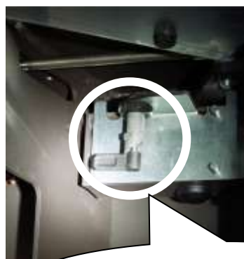
posizione di servizio del meccanismo di chiusura
