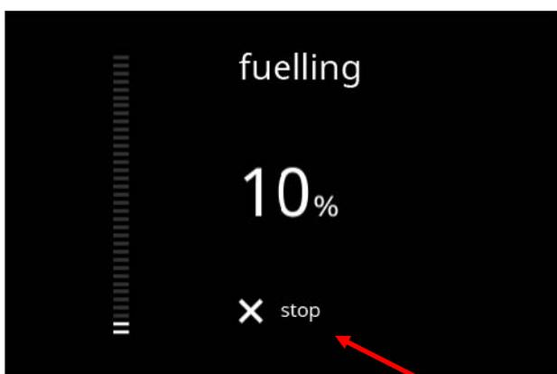
**Conseil !** Avant d'arrêter le ravitaillement, sortez le tuyau de carburant du réservoir et soulevez-le avec l'ouverture. Ensuite, attendez quelques secondes pour que la pompe pompe le carburant qui se trouve dans le tuyau de carburant. Ce n'est qu'alors que le tuyau peut être déconnecté du connecteur (installez le tuyau dans le module externe ARS-500).
