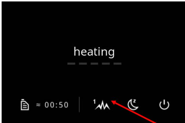
Ainsi que pendant la combustion (boutons "+" et "-"), où le mode de contrôle de la hauteur de la flamme est la commande principale.
