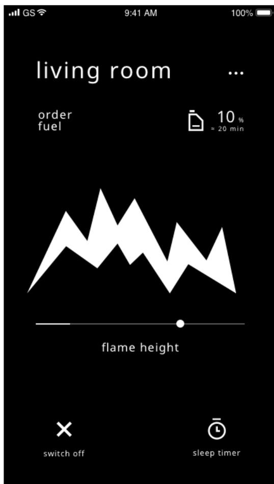
**Attention !** Lorsque vous modifiez la hauteur de la flamme pendant la combustion, il est nécessaire d'attendre un certain temps (15-30 secondes) pour que la hauteur de la flamme soit réglée.
