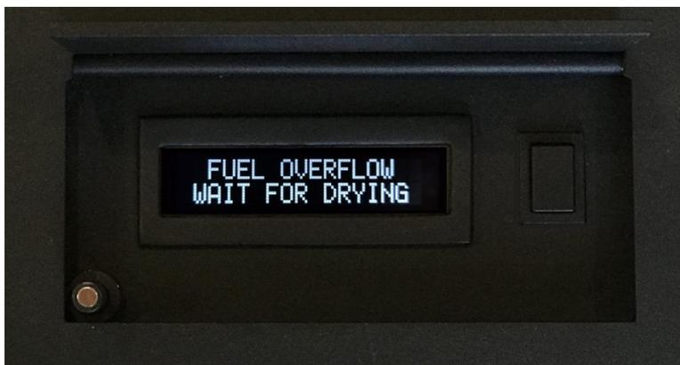
Dans ce cas, il est nécessaire d'arrêter immédiatement le remplissage de combustible, de retirer l'entonnoir et de fermer le couvercle du panneau de combustible. Le foyer se verrouille et les ventilateurs restent allumés. N'éteignez pas le bouton d'alimentation et n'essayez pas d'allumer le foyer. Attendez jusqu'à que le combustible ait disparu l'inscription READY s'affiche à l'écran
