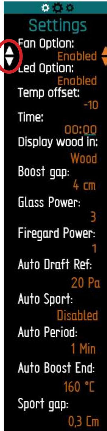
**Option Fan :** Un ventilateur est une option. Si votre foyer est équipé d'un ventilateur mettre ce paramètre sur Actif (Enabled = actif , Disabled = inactif)
