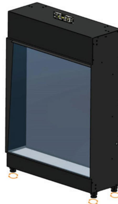
Placez l'appareil dans sa position d'installation finale. Une fois en place, placez un niveau sur l'appareil pour vous assurer qu'il est de niveau. Si l'appareil n'est pas de niveau, des pieds de réglage se trouvent à la base de l'appareil pour en modifier la hauteur. Vissez/dévissez les pieds de réglage à la main pour obtenir la hauteur souhaitée.
