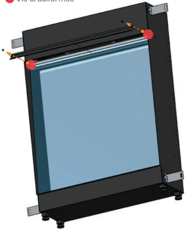
3) Soulevez la vitre pour la sortir de l'appareil et posez-la sur une surface douce et plane.
