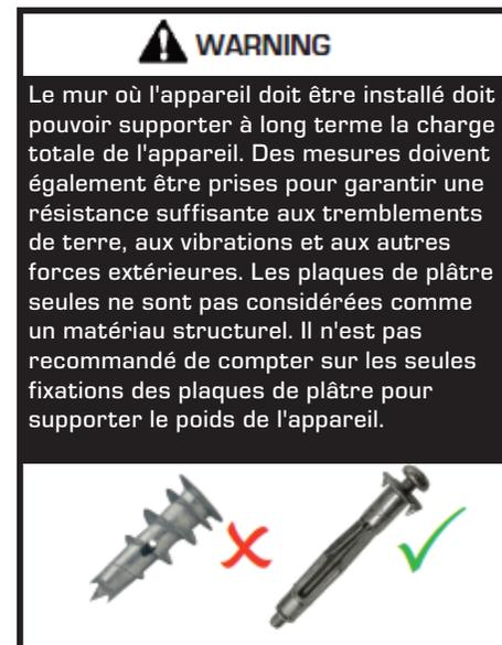
Vérifiez régulièrement la sécurité des fixations murales, le cas échéant. Vérifiez également la sécurité du câble d'alimentation et des connexions. Si le câble d'alimentation est endommagé, il doit être remplacé par un agent de service ou une personne compétente, telle qu'un électricien qualifié.
