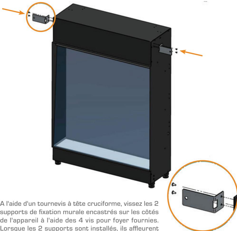
A l'aide d'un tournevis à tête cruciforme, vissez les 2 supports de fixation murale encastrés sur les côtés de l'appareil à l'aide des 4 vis pour foyer fournies. Lorsque les 2 supports sont installés, ils affleurent la face avant de la chambre de combustion.
