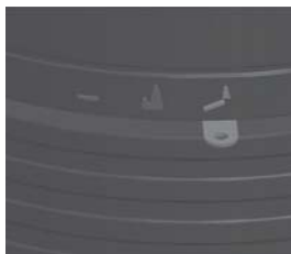
Fig. 5.10 Régulateur d'air de combustion tout à droite : air complètement ouvert
