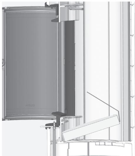
Fig. 4.27 Levage de la foyère dans la chambre de combustion
