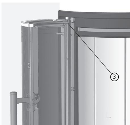
Fig. 3.7 Vis sans tête, desserrage du cliquet de sécurité
