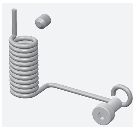
Fig. 3.10 Ressort de porte et les vis de fixation
