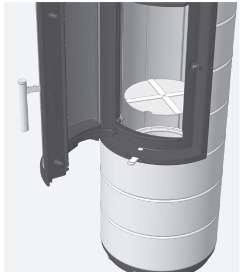
Fig. 4.31 Sortie de la tôle foyère de la chambre de combustion
