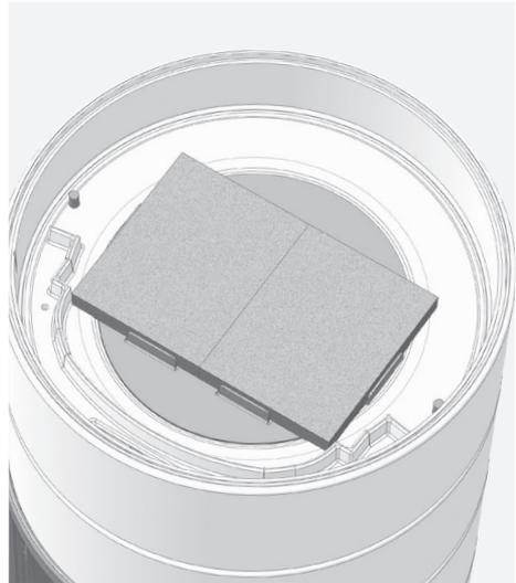
Fig. 4.34 Position des plaques du catalyseur du PEPPA tec
