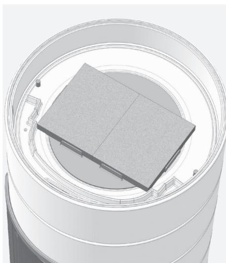
Fig. 3.4 Position des plaques des de catalyseur du PEPPA, vue de dessus, couvercle ôté
