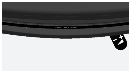
Fig. 4.5 Arrivée d'air tout ouverte, tirette tout à droite
