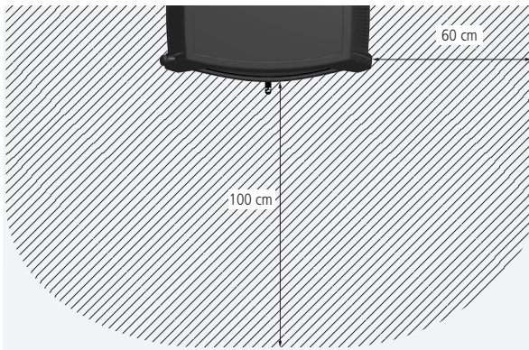
Fig. 1.6 Distance de sécurité devant la vitre du poêle APELLA / APELLA small
