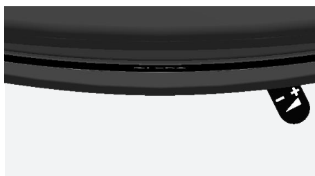
Fig. 4.11 Arrivée d'air à brûler grande ouverte, tirette tout à droite
