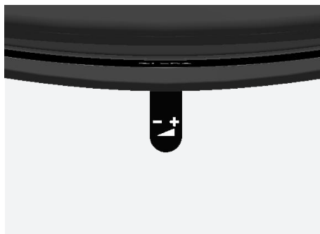
Fig. 4.15 Arrivée d'air de combustion env. 25% à 50% ouvert
