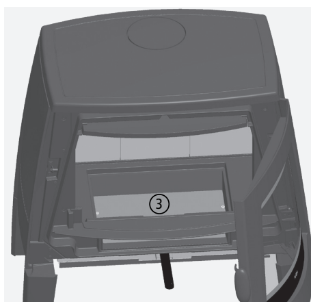
Fig. 4.20 nettoyer la tôle foyère / compartiment à cendre
