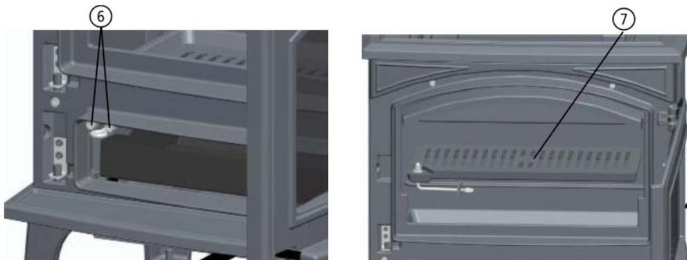
Maintenant la chambre de combustion et conduit de fumée peuvent être nettoyés correctement avec une brosse appropriée. Il est préférable de retirer les restes de cendres avec par exemple un aspirateur à cendres.
