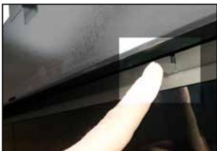
Au dessus de la vitre (en dessous de la baguette supérieure), sont prévus des crochets (à gauche, droite et au milieu). Soulever légèrement avec vos doigts. La vitre peut maintenant basculer sous 45°.
