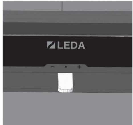
Fig. 3.5 Régulateur d'air au milieu, symbole « + » air de combustion mi-ouvert
