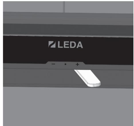
Fig. 3.12 Régulateur d'air à droite, symbole « + », jusqu'à la butée air de combustion complètement ouvert
