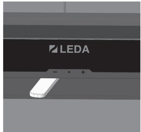
Fig. 3.13 Régulateur d'air tout à gauche, symbole « - », air de combustion fermée
