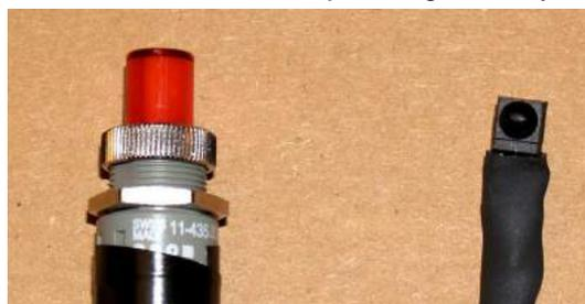
Photo 2 Bouton presseur arrêt réarmement Récepteur IR
