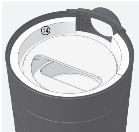
Fig. 3.12 Insérer le joint en non-tissé sur le pourtour du dernier insert d'accumulateur (rehausse avec raccordement par l'arrière)
