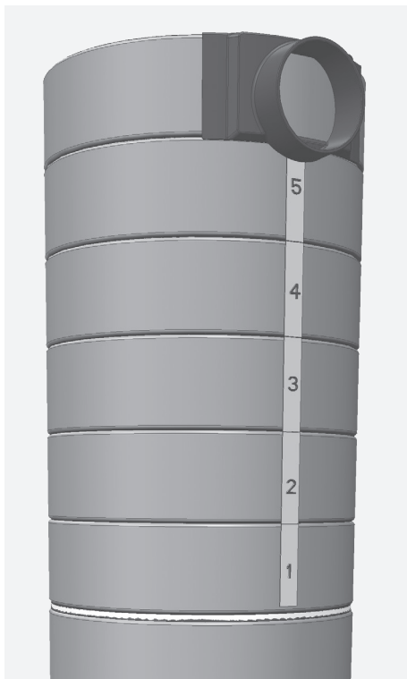
Fig. 3.1 Marquage de la rehausse avec sortie arrière
