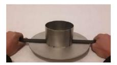
Les deux barres sont utilisées comme lève-couvercle. Le tube en verre peut rester en position. La tige la plus longue est utilisée pour nettoyer le brûleur.
