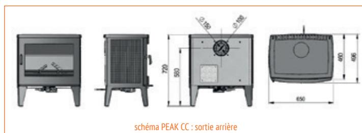
schéma PEAK CC : sortie arrière
