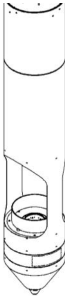
Illustration 12 - Cheminée correctement assem-
