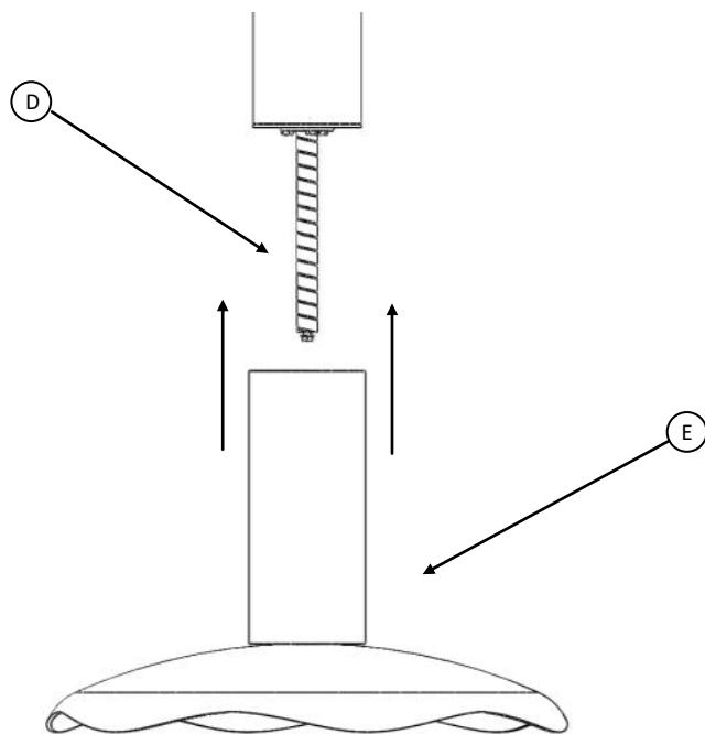
Vissez le component (E) dans le dispositif de suspension (D).
