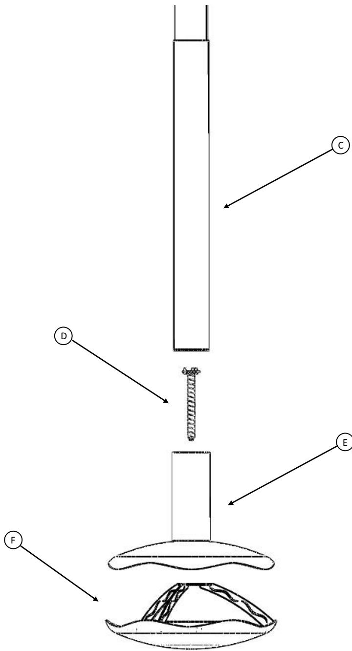
Commencez l'installation avec la fixation du component (D) la structure (C), les trous situés au bas de la structure (C), en utilisant les vis fournies.
