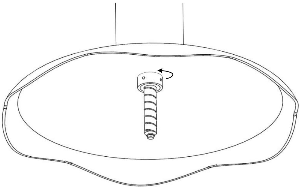
Pour finaliser, visser le component (F) au component (D), à l'aide de la vis et la rondelle fournie.
