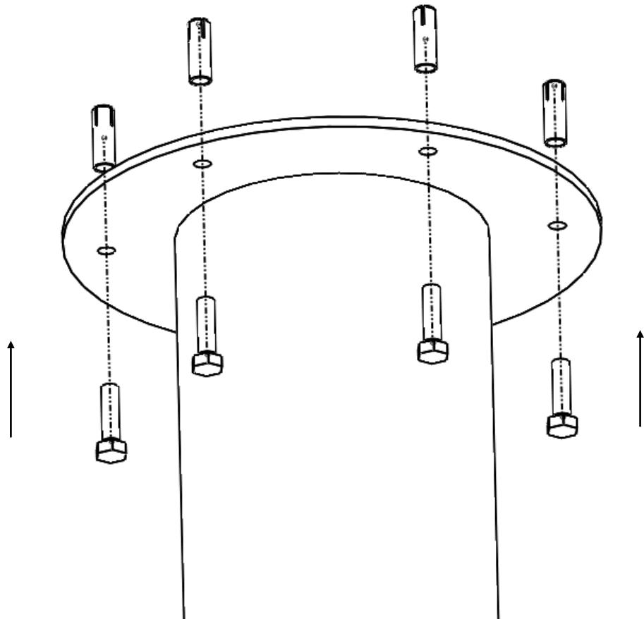
**Avertissement: Le plafond doit avoir une structure suffisamment solide pour supporter le poids du modèle. Il est interdit de mettre des poids supplémentaire sur la cheminée.**
