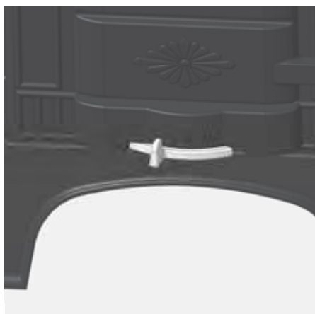
Fig. 4.4 Curseur d'air de combustion complètement à gauche, repère « I », air de combustion fermé
