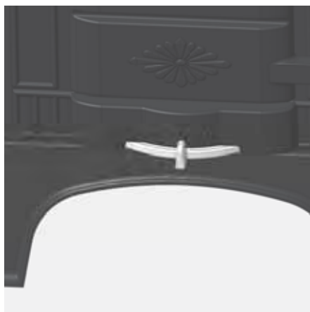
Fig. 4.5 Curseur d'air de combustion en position centrale, repère « II », air de combustion pour la puissance thermique nominale
